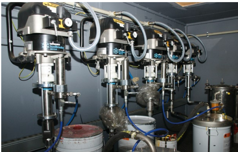
Kuchnia farb znajduje się na zewnątrz kabiny malarskiej.
