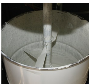
System sam miesza i dozjuje farbę, utwardzacz oraz rozpuszczalnik.
